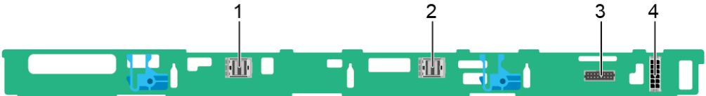
图 5-34 4x3.5 英寸硬盘直通配置背板
