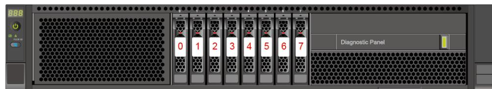
图 5-18 硬盘编号 ( IO3 配置 NVMe 硬盘 )
