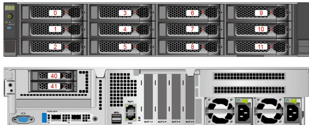
图 5-27 硬盘编号 ( IO 模组 1 配置 3.5 英寸硬盘 )
