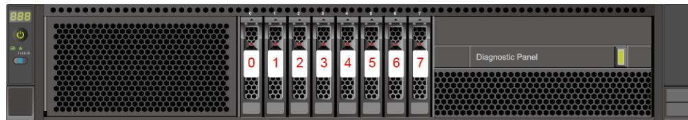
图 5-16 硬盘编号 ( IO3 配置 NVMe 硬盘 )
