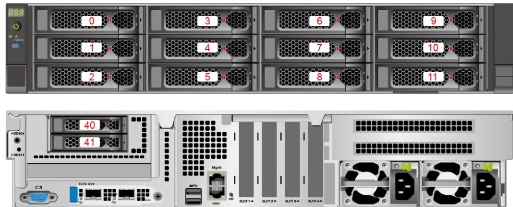
图 5-29 硬盘编号 (IO 模组 1 配置 3.5 英寸硬盘)
