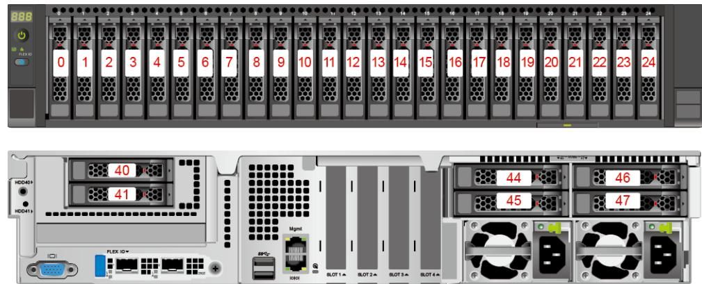
图 5-42 硬盘编号 ( IO 模组 1 配置 2.5 英寸硬盘+IO 模组 3 配置 SAS/SATA 硬盘 )
