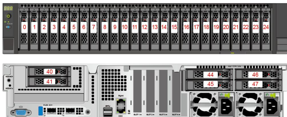
图 5-38 硬盘编号 ( IO 模组 1 配置 3.5 英寸硬盘+IO 模组 3 配置 NVMe 硬盘 )
