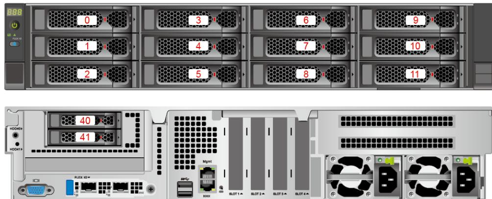
图 5-35 硬盘编号 (IO 模组 1 配置 3.5 英寸硬盘)
