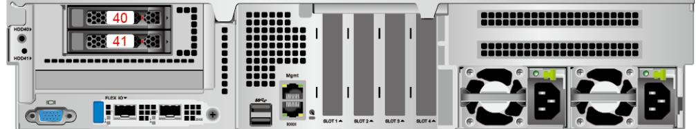
图 5-24 硬盘编号 (IO 模组 1 配置 2.5 英寸硬盘+IO 模组 3 配置 NVMe 硬盘)
