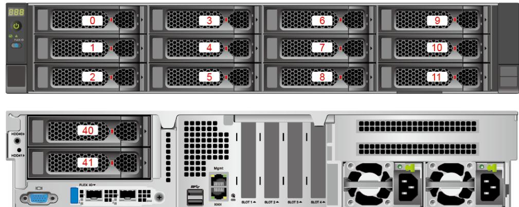
图 5-20 硬盘编号 ( IO 模组 1 配置 3.5 英寸硬盘+IO 模组 3 配置 NVMe 硬盘 )
