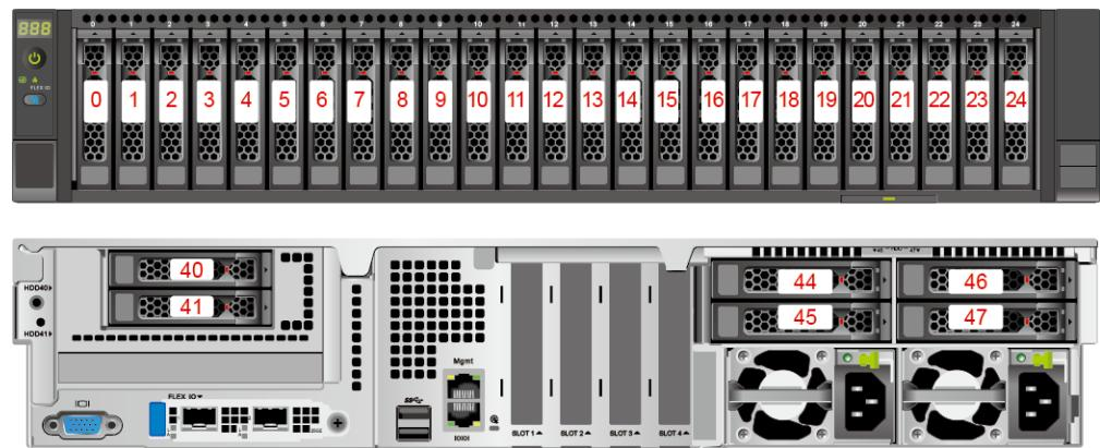
图 5-43 硬盘编号 ( IO 模组 1 配置 3.5 英寸硬盘+IO 模组 3 配置 SAS/SATA 硬盘 )
