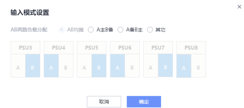
图 7-4 iBMC WebUI A/B 两路负载均摊模式
