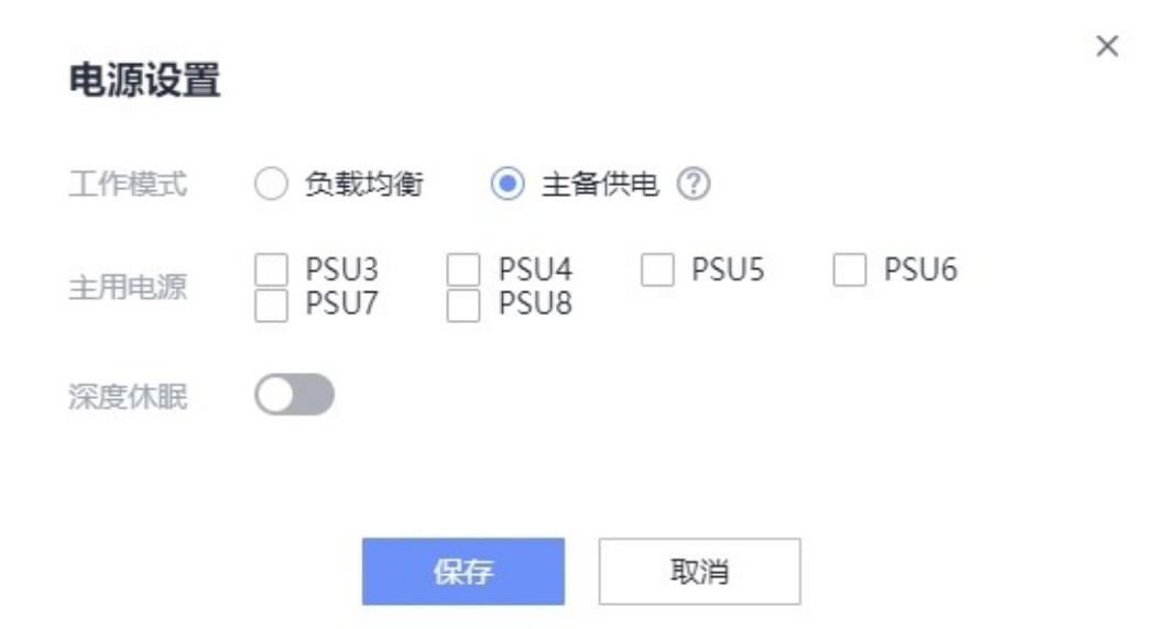
图 7-9 54V 电源备份方式设置 2
