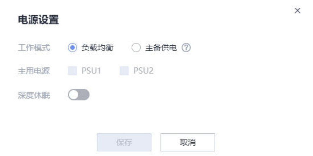
图 7-7 12V 电源备份方式设置
